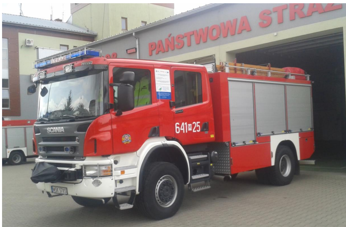
Ciężki samochód ratowniczo – gaśniczy z funkcją ograniczania stref skażeń SCANIA P400 CP28 4X4 (GCBA 5/36/2,8) rok produkcji 2012
