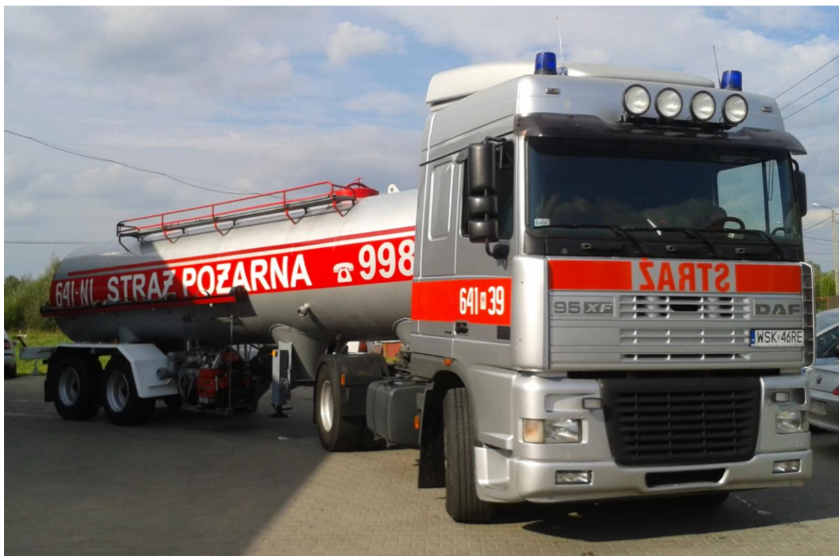
Ciągnik siodłowy DAF rok produkcji 2002 Naczepa - cysterna o pojemności 18 m 3 rok produkcji 1984. (GCBM 18/13)
