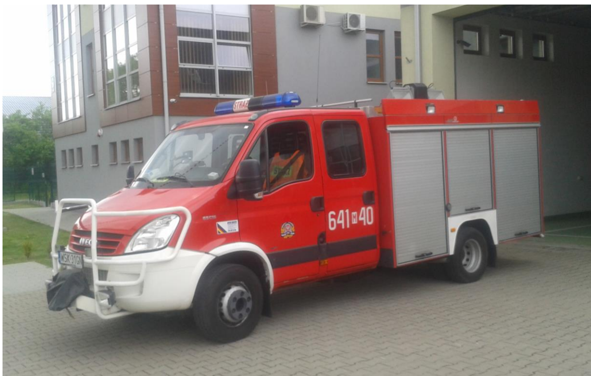
Lekki samochód ratowniczo gaśniczy z funkcją wytwarzania piany gaśniczej przy użyciu gazów spalinowych na podwoziu IVECO DAILY 65C15D typ 661 (GLBA 1/1+Rt) rok produkcji 2006.
