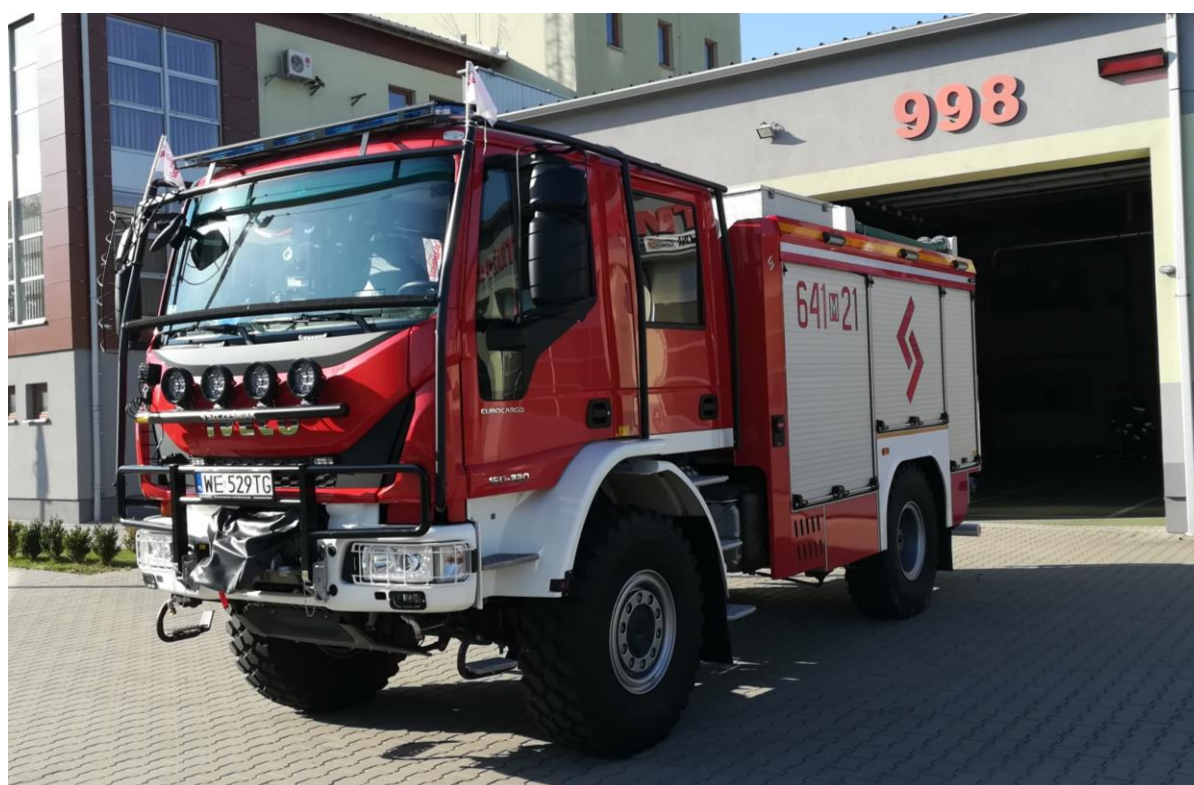
Lekki samochód ratowniczo gaśniczy z funkcją wytwarzania piany gaśniczej przy użyciu gazów spalinowych na podwoziu IVECO DAILY 65C15D typ 661 (GLBA 1/1+Rt) rok produkcji 2006.
