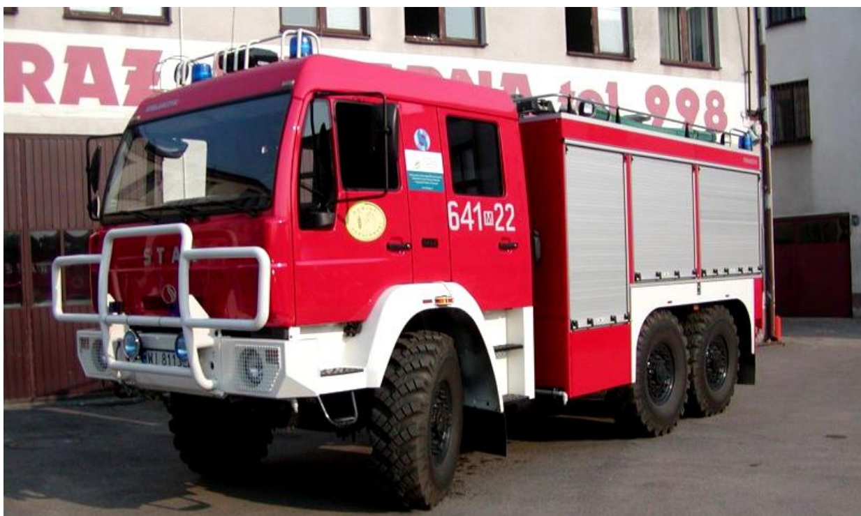
Średni uterenowiony samochód ratowniczo-gaśniczy z funkcją do ograniczania stref skażeń na podwoziu STAR M – 90 6 x 6 (GBA 2,5/20) rok produkcji 2005.
